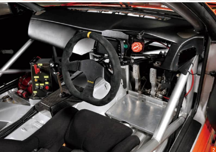
1 シートを後退させることで、より車両の中心に寄せているドライバーポジション。2 S14シルビアのcockpit。ドライバー左側にはキルスイッチ、スタート、ワイパー、イグニッション、燃料ポンプスイッチが並ぶ。3 メーター右に備わるブレーキバランスのダイヤル。
