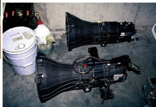
ル・マンでのエースカーは、よりハイパワーなエンジンとXトラックのシーケンシャルミッションを装備する23号車。しかし一方で、そのギヤボックスには耐久性に難があり、スベア2基を用意して臨んでいた。
