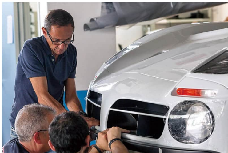
R33よりも高い熱量(?)を向けるコマスのR390GT1は98年ル・マンでドライブした30号車。マシンは完全に解体され3年をかけてフルレストアを敢行、カラーリングはもちろん全てが新車同然となって蘇った。エアコンを追加し、ボディカバーは新調した。
