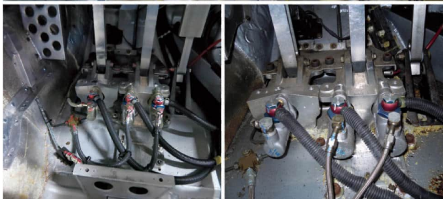
オイル漏れやブレーキフルードでサビが浮いていたフロアやABCペダル周辺は、クリーニング後に補修されて元のとおりに。レース用のワンオフパーツも多く、その補修には苦勞したとスタッフは回想する。
