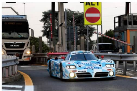
R33よりも高い熱量(?)を向けるコマスのR390GT1は98年ル・マンでドライブした30号車。マシンは完全に解体され3年をかけてフルレストアを敢行、カラーリングはもちろん全てが新車同然となって蘇った。エアコンを追加し、ボディカバーは新調した。
