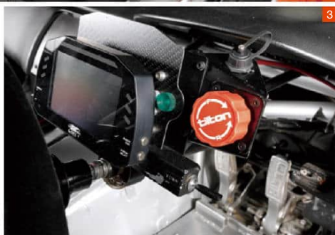
1 シートを後退させることで、より車両の中心に寄せているドライバーポジション。2 S14シルビアのcockpit。ドライバー左側にはキルスイッチ、スタート、ワイパー、イグニッション、燃料ポンプスイッチが並ぶ。3 メーター右に備わるブレーキバランスのダイヤル。
